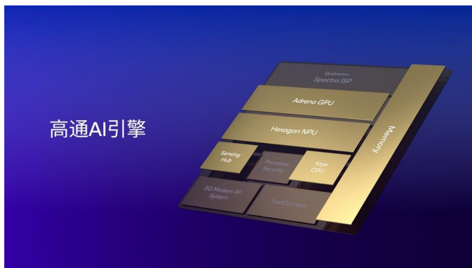
图 6：高通 AI 引擎包括 Hexagon NPU、Adreno GPU、高通 Kryo 或高通 Oryon CPU、高通传感器中枢和内存子系统。
